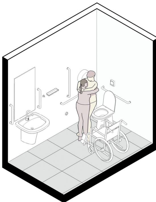
Não poderão ser utilizados vasos sanitários com abertura frontal nem assentos de altura diferenciada para cumprimento das normas de acessibilidade.
